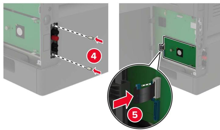
7 Si nécessaire, fixez le disque dur au port ISP.
