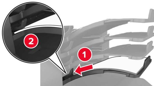
**Remarque :** Un bourrage se produit en raison d'une surcharge du réceptacle si le papier n'est pas placé sous le bras du réceptacle.
