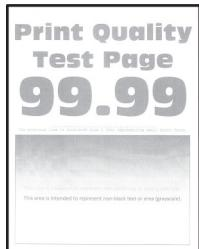
**Remarque :** Avant de résoudre le problème, imprimez les pages de test de qualité d'impression. A partir du panneau de commandes, accédez à **Paramètres > Dépannage > Pages de test de qualité d'impression**.
