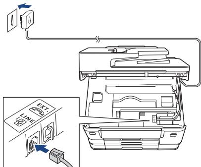
Insérez le cordon de la ligne téléphonique dans la prise portant l'indication **LINE** et acheminez le cordon à l'arrière de l'appareil.
