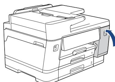
Après avoir installé les quatre réservoirs d'encre, fermez le couvercle des cartouches d'encre.
