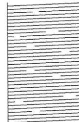
Sur l'écran LCD de l'appareil, sélectionnez les images qui correspondent le mieux à l'image pour chaque couleur sur la page de contrôle de la qualité d'impression, puis relancez la procédure de nettoyage, si nécessaire.
